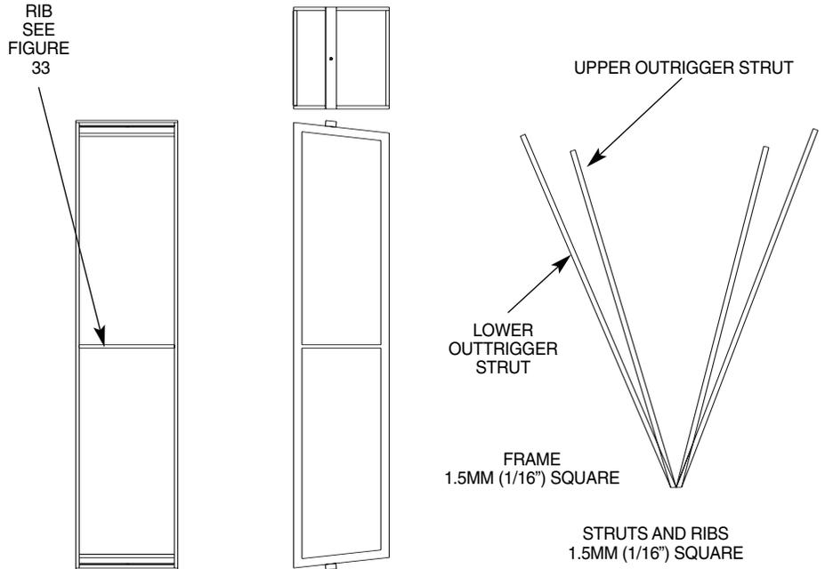
**FIG. 33 RUDDER ASSEMBLY**
